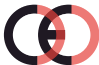
Falsk CE-mærke (for tæt på hinanden)
